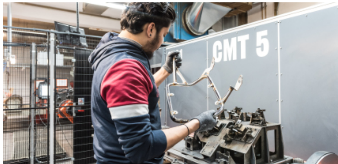
Während der Roboter auf der anderen Seite des Drehtisches schweißt, entnimmt ein Mitarbeiter ein fertig geschweißtes Produkt und bestückt die Spannvorrichtung mit neuen Komponenten.
