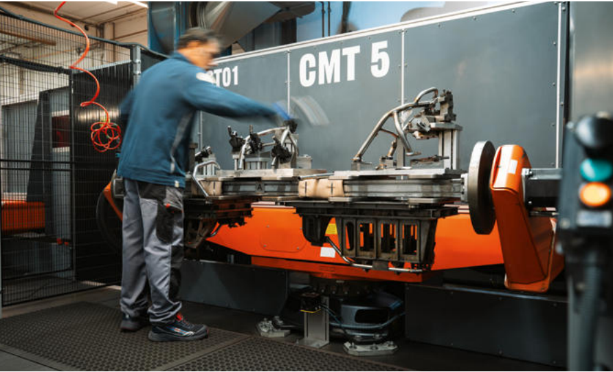
Bestückung der Vorrichtungen auf den Drehtischen der Schweißzellen (hier mit Sturzbügeln).
