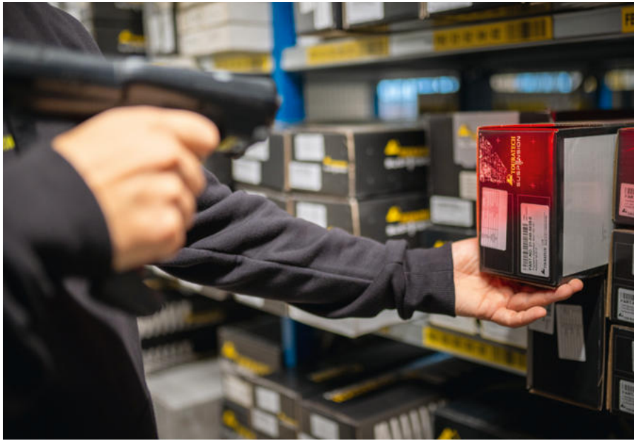
Per maschinenlesbarem Code ist jedem Produkt ein Lagerplatz zugeordnet.
