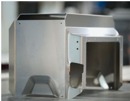
Kofferrohling als komplexes Biegeteil (I.). Automatisiertes Handling durch Roboter.
