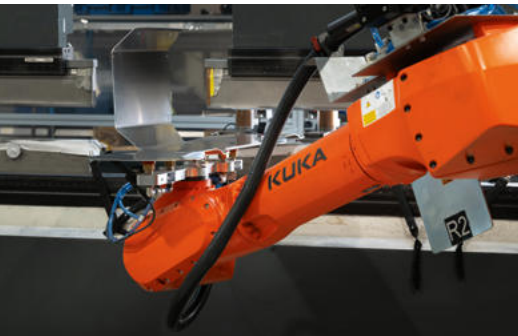
Kofferrohling als komplexes Biegeteil (I.). Automatisiertes Handling durch Roboter.
