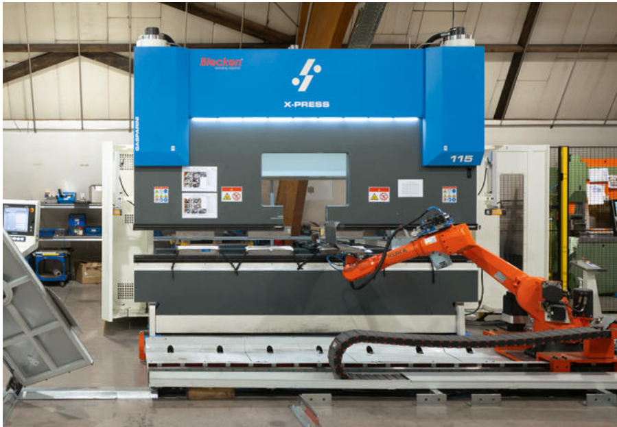
Die modernen Biegezellen ermöglichen mehrere Umformschritte in einem Prozess.
